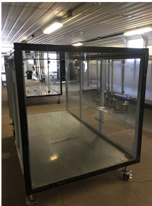
Figura 1. Foto da estrutura do túnel de vento que simula uma aplicação área de produtos fitossanitários.
