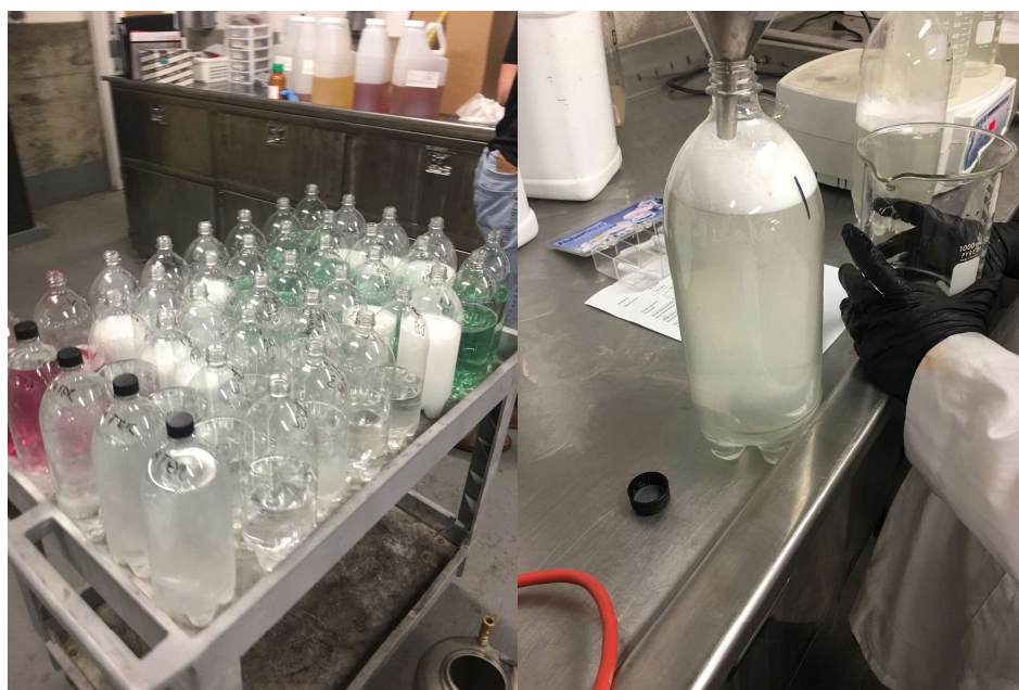
Figura 3. Fotos dos recipientes contendo 2 litros e do momento da realização da mistura entre os produtos com auxílio de beckers de 1 L para agitação magnética da solução.
