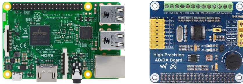
Figura 2.8: Controlador Raspberry Pi 3 (a) e placa de conversores AD/DA (b)
