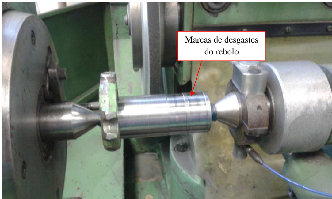
Figura 29 - Aspecto visual dos desgastes do rebolo impressos no cilindro.
