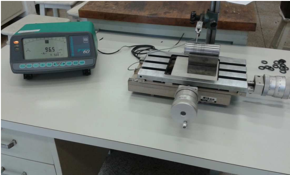
Figura 30 - Sistema utilizado para medição dos desgastes do rebolo.
