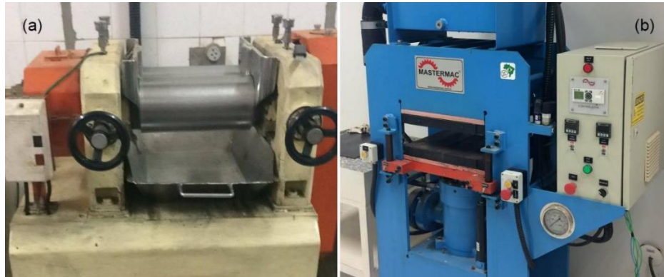
Figura 03: Fotografias: misturador aberto de cilindros da marca Makintec (a) e prensa hidráulica com sistema de aquecimento automatizado da marca Mastermac® (b).
