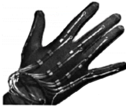
Figura 11 - DataGlove de neoprene e fibra de vidro
