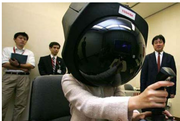
Figura 9 - Protótipo Helmet , da Toshiba, um capacete com visão 360°
