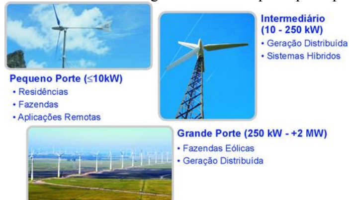
Figura 18 – Tamanho dos aerogeradores e suas principais aplicações.
