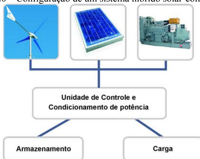
Figura 20 – Configuração de um sistema híbrido solar-eólico-diesel.
