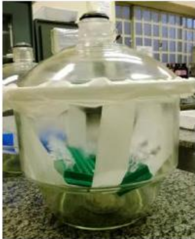
Figura 3. Amostras de biofilme acondicionadas em microtubos abertos, colocados sobre uma base acima da placa de petri contendo pentóxido de fósforo. Secagem do biofilme em jarra de anaerobiose (sob vácuo), por 12 horas.
