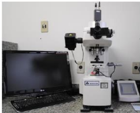
Figura 4. Microdurômetro Micromet 5114 Hardness Tester (Buehler, Lake Bluff, USA e Mitutoyo Corporation, Kanagawa, Japan), com penetrador (Knoop) acoplado ao Software para análise de imagem Buehler OminMet (Buehler, Lake Bluff, USA).
