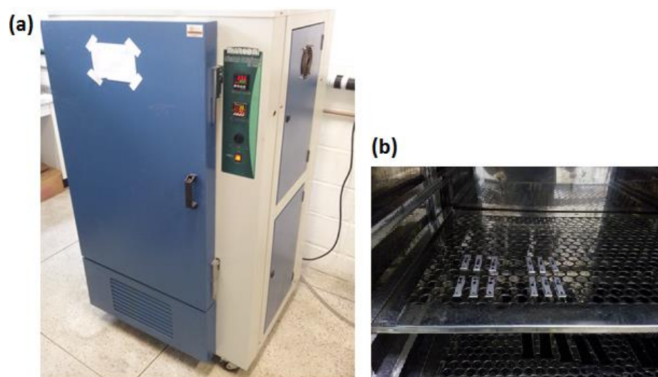
Figura 40– a) Câmara de condicionamento higrotérmico da marca Marconi; b) e detalhes de seu interior.
