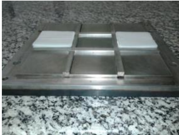
Figura 29 - Molde com etapas de preparo já realizadas, pronto para início de prensagem.
