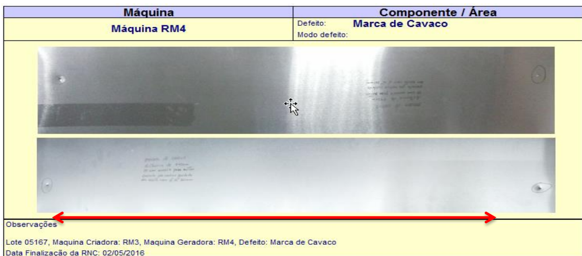
Figura 13 – Exemplo do Defeito Marca de cavaco
