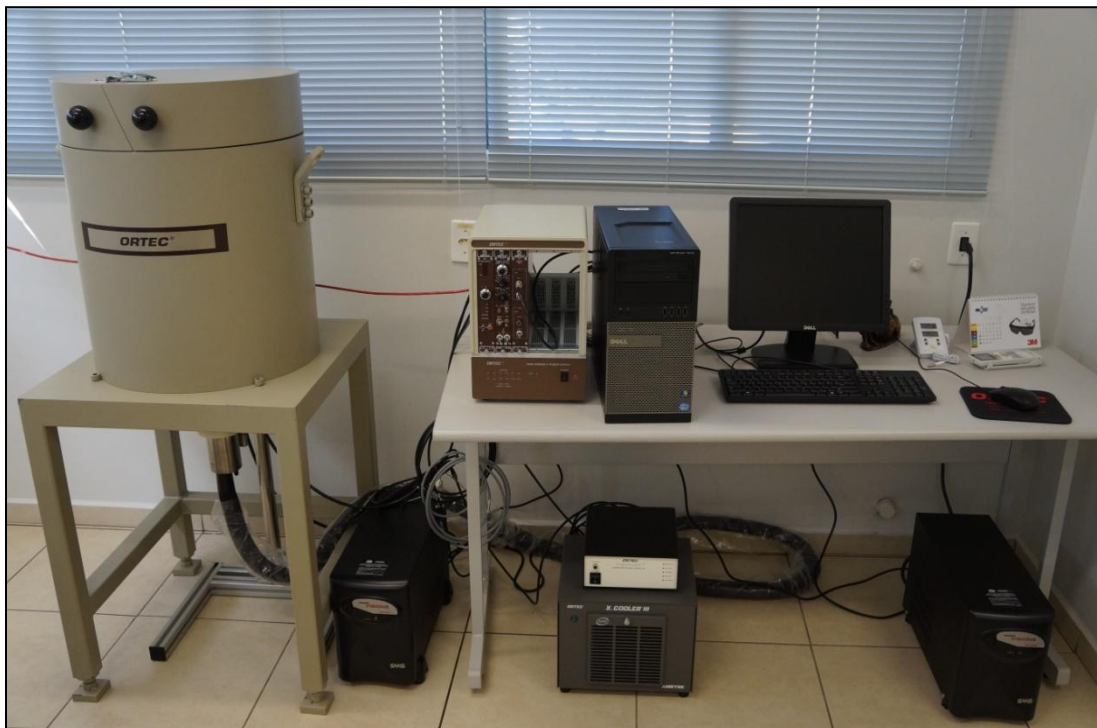
Figura 14: aspecto geral do sistema espectrométrico instalado nas dependências da UNESPetro Rio Claro, com destaque para a blindagem maciça de chumbo na qual está inserida o detector (canto esquerdo).
