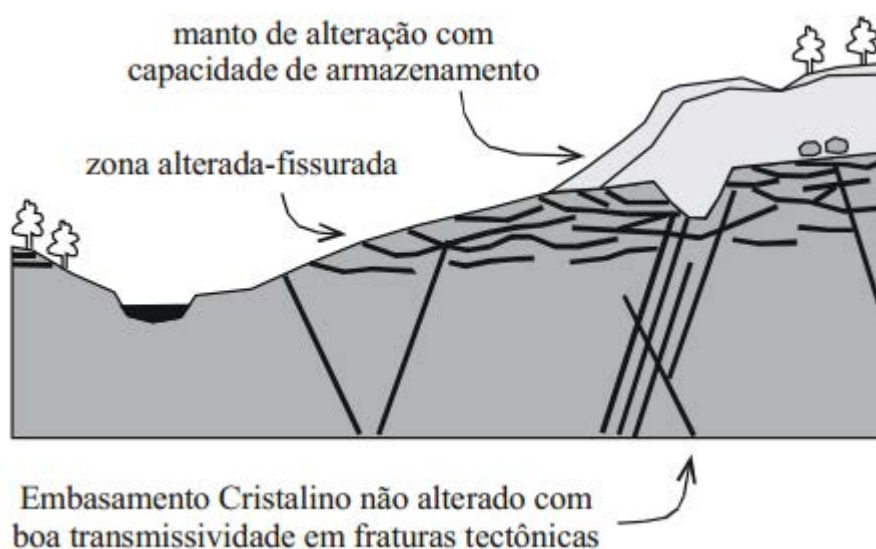
Figura 14: Modelo do perfil de alteração e seu controle sobre os aquíferos em rochas cristalinas (Lachassagne et al., 2001).
