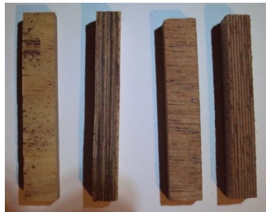
Figura 14_Corpo de prova para o teste de inchamento.
