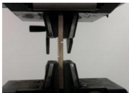
Figura 17_Ensaio de cisalhamento na Máquina Universal de Ensaio.
