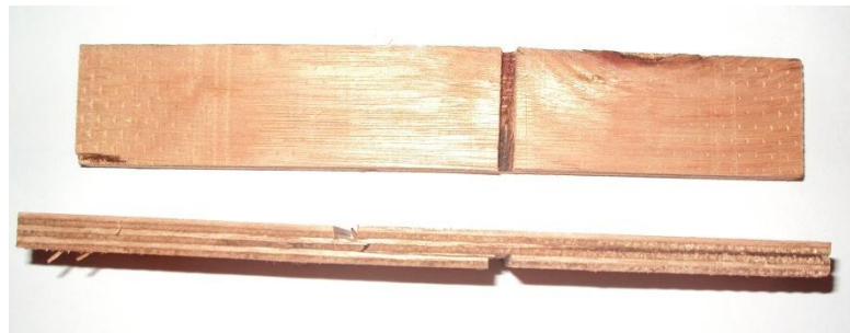
Figura 16_Corpo de prova para o teste de cisalhamento na linha de cola.
