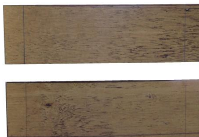
Figura 19_Corpo de prova para o teste de flexão.
