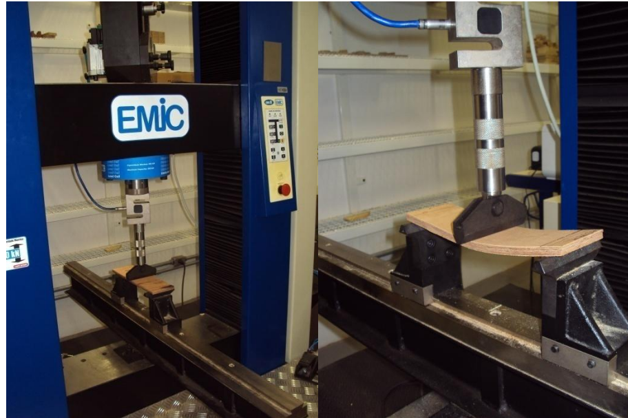
Figura 20_Ensaio de flexão na Máquina Universal de Ensaios.
