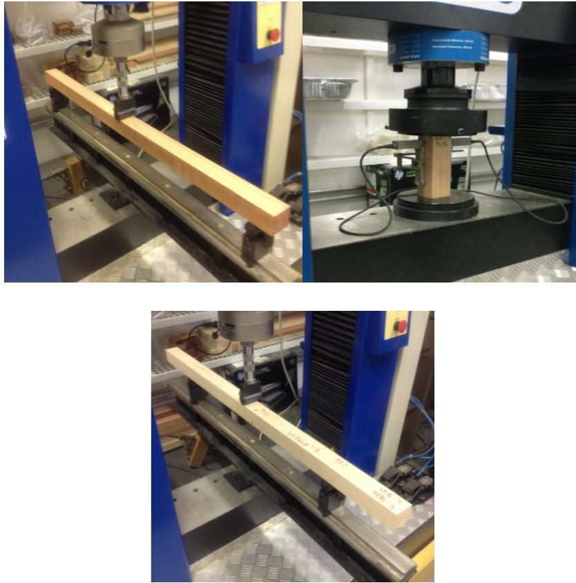
Figura 11 - Ensaio de compressão e flexão estática.
