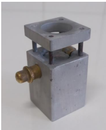
Figura 1 – Dispositivo utilizado para padronização da distância no jateamento
