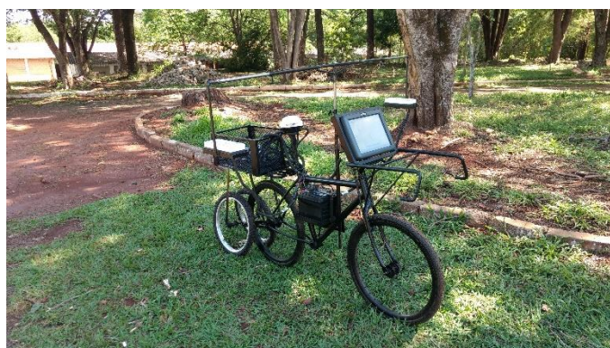
Figura 4. Bicicleta com suporte confeccionado pelo LAMMA, que foi utilizado para o transporte do sensor OptRx durante a coleta dos dados a campo.
