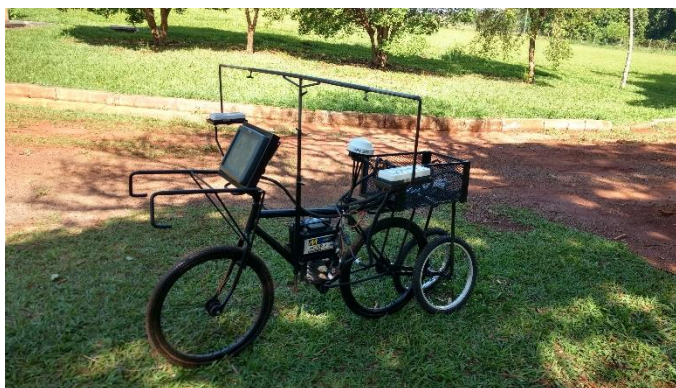
Fig. 4 Suporte confeccionado pelo LAMMA, para transportar o sensor OptRx, para a coleta dos dados a campo.
