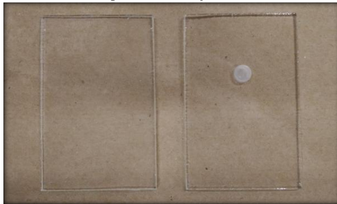
Figura 34- Porta amostra de vidro fabricado para acomodação da camada de carbono coletada após a realização de ataque para desprendimento à partir da superfície do corpo de prova. (Esquerda) Corpo de prova confeccionado e (Direita) Corpo de prova confeccionado, após usinagem do rebaixo côncavo para acomodação da camada de carbono coletada.
