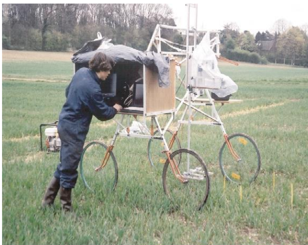
Figura 12 - Veículo no qual o espectrômetro foi montado; o sistema podia se mover livremente sobre o dossel.
