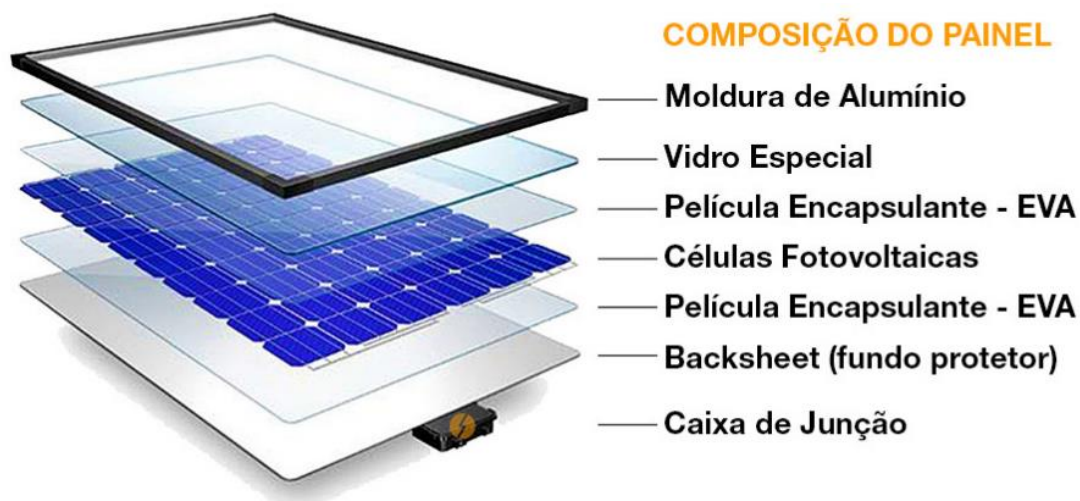
Figura 10. Composição de um módulo solar típico. Componentes: Moldura de Alumínio – adiciona robustez ao painel e garante sua integridade; Vidro Especial – vidro temperado ultra puro com baixo teor de ferro revestido com uma substância antirreflexiva, desenvolvido para refletir menos e deixar o máximo de luz passar através dele; Células Fotovoltaicas – Transforma a luz do sol em energia elétrica através de uma reação físico-química, representa aproximadamente 60% do custo do modelo solar; Película Encapsulante – EVA – material selante que protege as células fotovoltaicas do envelhecimento causado por raios UV, temperaturas extremas e umidade; Backsheet – material plástico e branco que protege os componentes internos do módulo solar e agir como um isolante elétrico; e Caixa de Junção – local onde as células solares são conectadas eletricamente. Fonte: Portal Solar, 2016.
