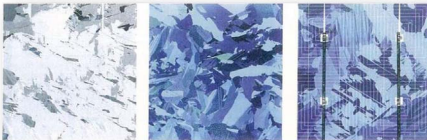
Figura 16. Células fotovoltaicas e módulo solar de silício policristalino. Fonte: Di Souza, 2013.
