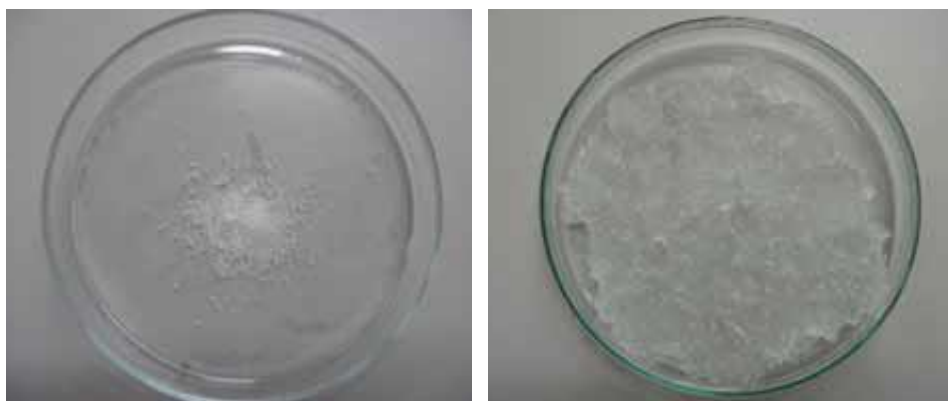
Figura 3 - SAP seco, em grão, e SAP hidratado com água destilada, respectivamente.
