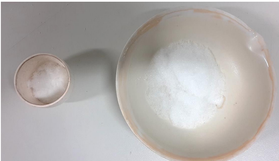
Figura 11 - Amostra de SAP seco e de SAP hidratado, respectivamente.
