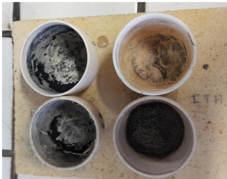
Figura 13 - Cadinhos com amostras após calcinação (direito inferior, com amostra de SAP seco, e demais, com amostra de lodo).
