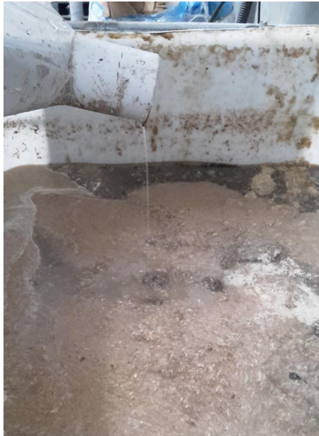
Figura 8 - Imagem tirada do efluente na saída da máquina, onde as fraldas descartáveis são trituradas e lavadas.
