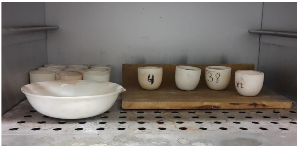
Figura 12 - Cadinhos com amostras dentro da estufa.
