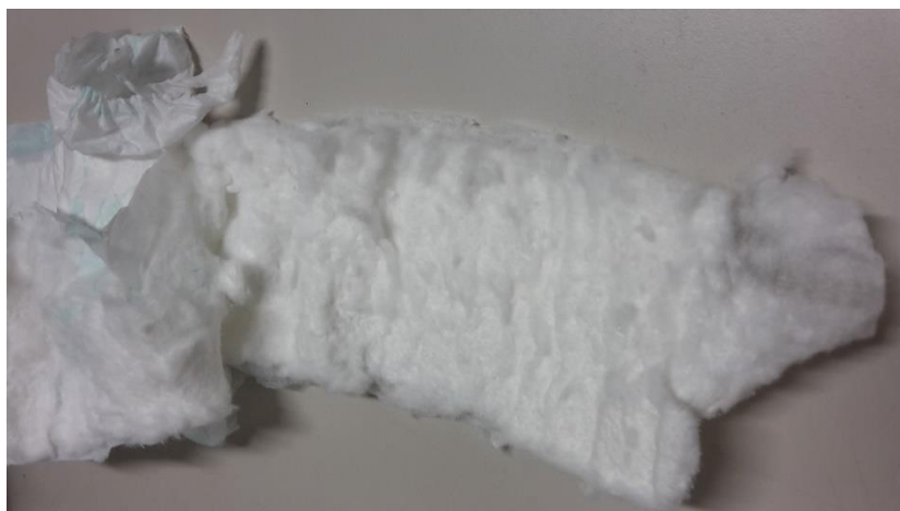
Figura 10 - Fralda descartável cortada, para obtenção do SAP.
