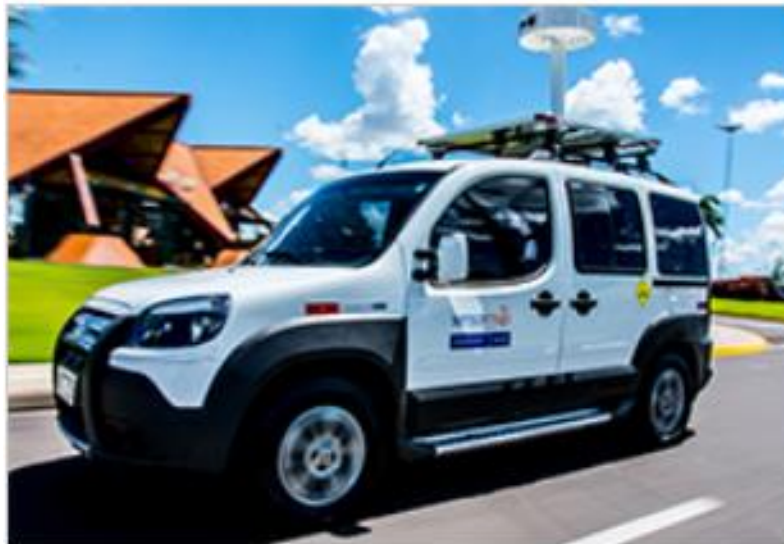
Figura 9 – Automóvel que executa o Mapeamento Móvel Digital Terrestre
