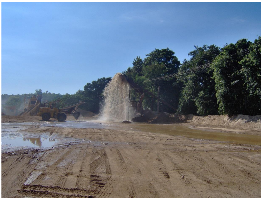
Figura A2-2: Maquinário em atividade e dragagem e lavagem da matéria prima extraída. Além da rala vegetação somente na parte bem próxima ao rio, encontrou-se uma cava de extração alagada a poucos metros do curso hídrico.
