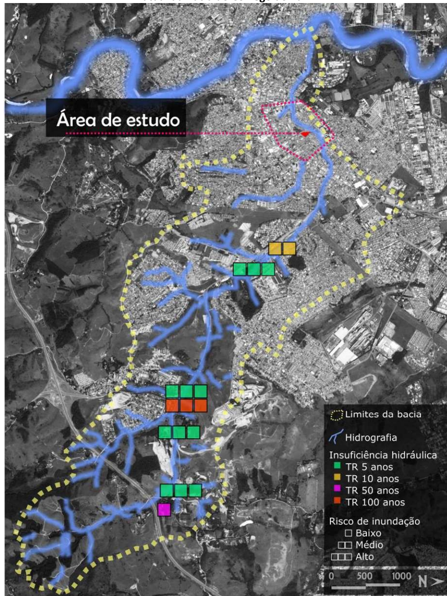
Figura 28 - Identificação das insuficiências do sistema hidráulico e risco de inundação atual da Bacia do Córrego do Turi.
