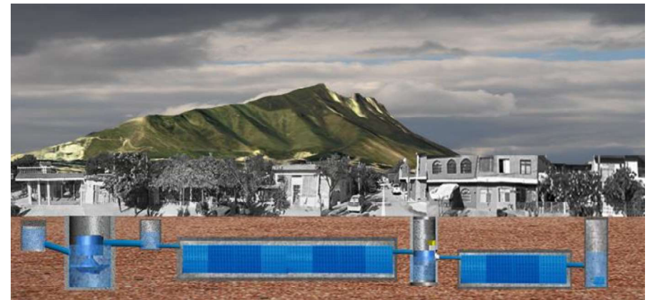
Figura 25 – Esquema do sistema de tratamento e reservação de águas pluviais no Paseo Edison.
