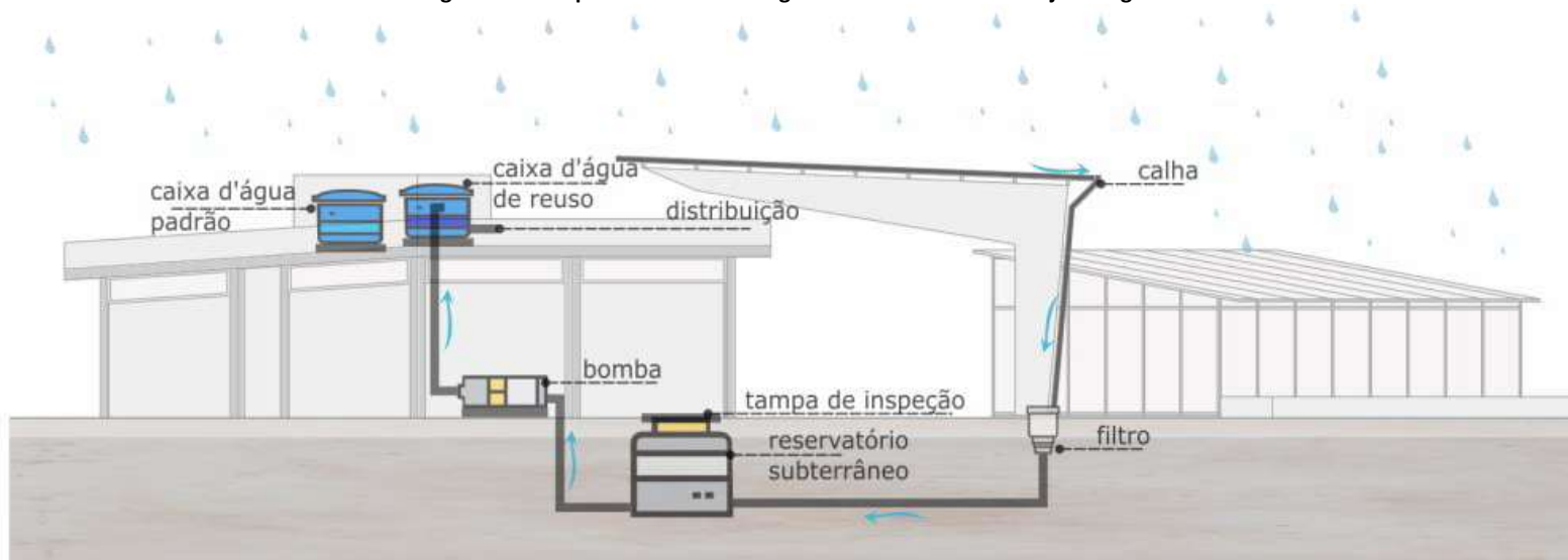
Figura 100 - Esquema de reuso de água da chuva na oficina de jardinagem.
