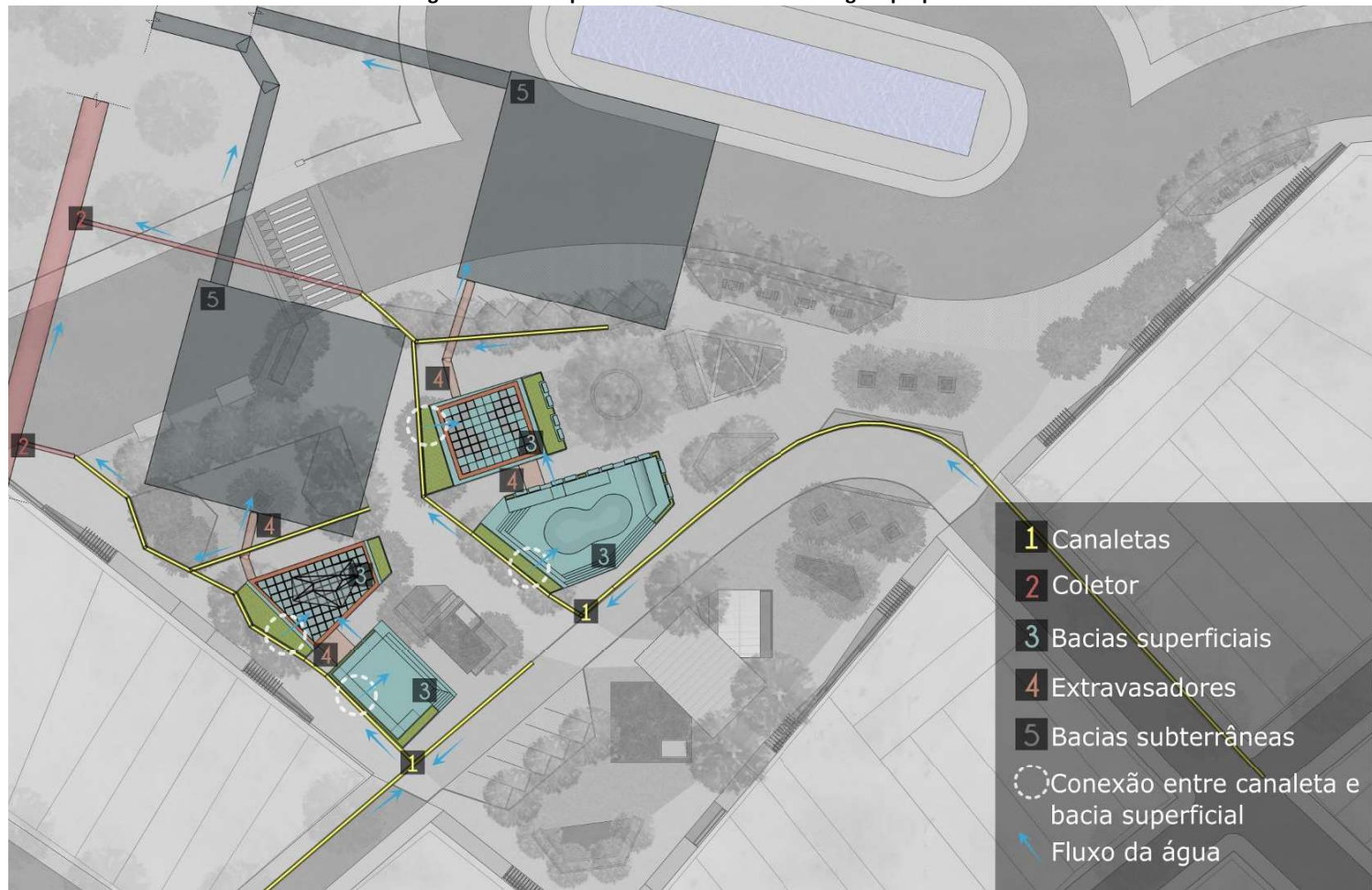
Figura 101 – Componentes do sistema de drenagem proposto.
