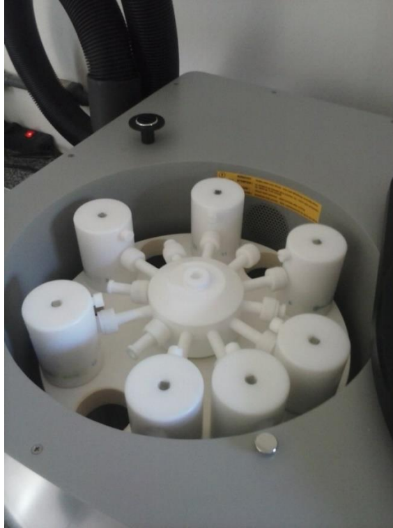
Figura 4 – Equipamento de micro-ondas utilizado na digestão de amostras de solo, com sete frascos de TFM, contendo a mistura de ácidos e amostra de solo, encaixados e prontos para o início da digestão.
