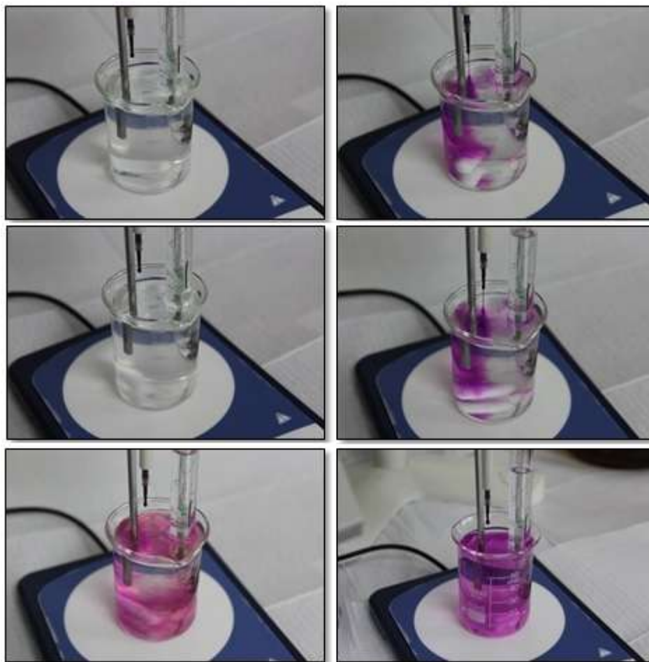
Figura 5- Reação de Titulação. a) solução transparente previamente à adição de permanganato; b) alíquota de permanganato dispensada na solução que se torna brevemente roxa; c) a solução torna à cor inicial; d) alíquotas de permanganato sendo dispensada; e) solução apresenta cor rósea; f) final da titulação com detecção da concentração de peróxido de hidrogênio e a solução se apresenta com coloração constante arroxeadada.
