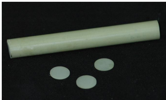
Figura 3 – Resina Epoxica: material análogo à dentina.
