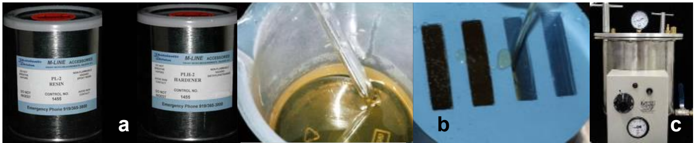
Figura 8. Resina fotoelástica PL 2 (a), manipulação e vazamento da resina fotoelástica (b) e resina sob pressão de 40 lbf/pol 2 (c).
