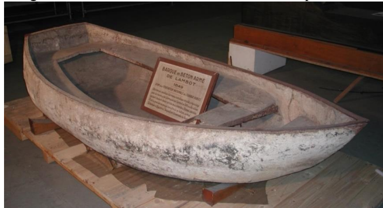
Figura 2 - Barco de concreto armado de Joseph Lambot
