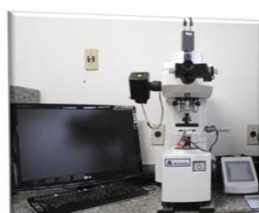
Microdurômetro Buehler Carga 5g; Tempo 10 segundos
