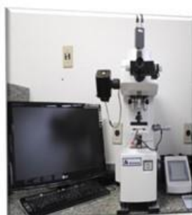
Microdurometro Buehler Carga 5g; Tempo 10 segundos
