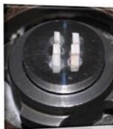
Embutimento dos blocos de esmalte com resina acrílica
