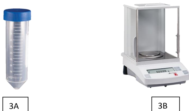
Figura 3. A- Tubo falcon 50ml. B- Balança analítica Adventurer®-AR Analytical (Ohaus Corporation, Parsippany, EUA)
