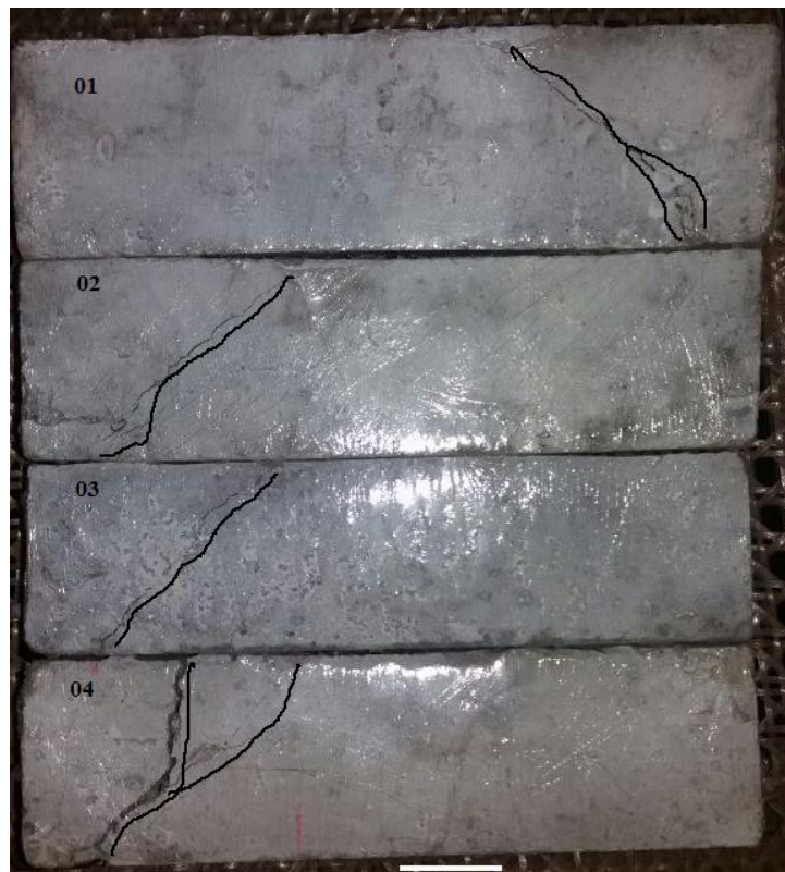
Figura 44 - Ruptura CDP 01 a 04.
