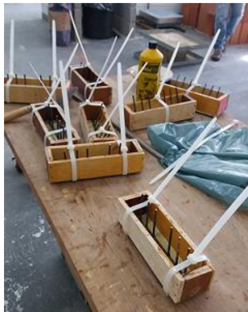
Figura 22- Formas para concretagem.
