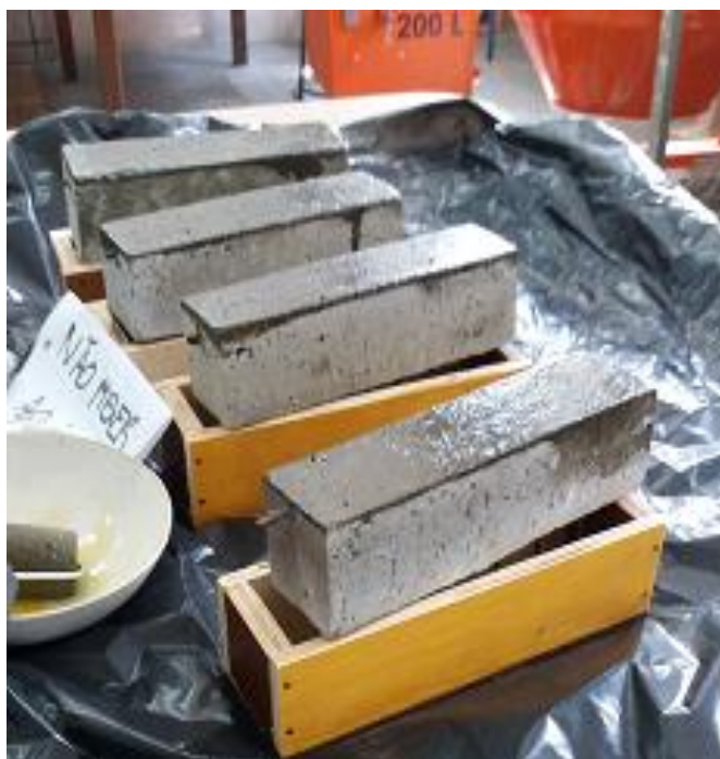
Figura 24 - Vigas com Viapol Carbon Primer .
