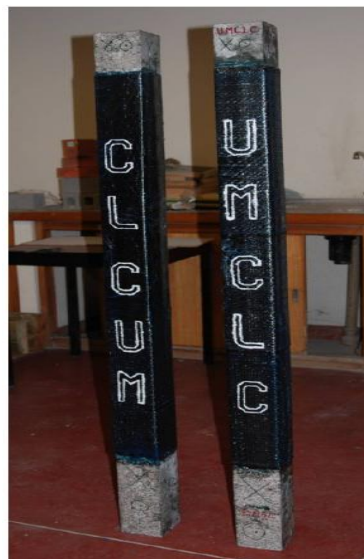
Figura 9 - Peça reforçada por confinamento e testes sísmicos.
