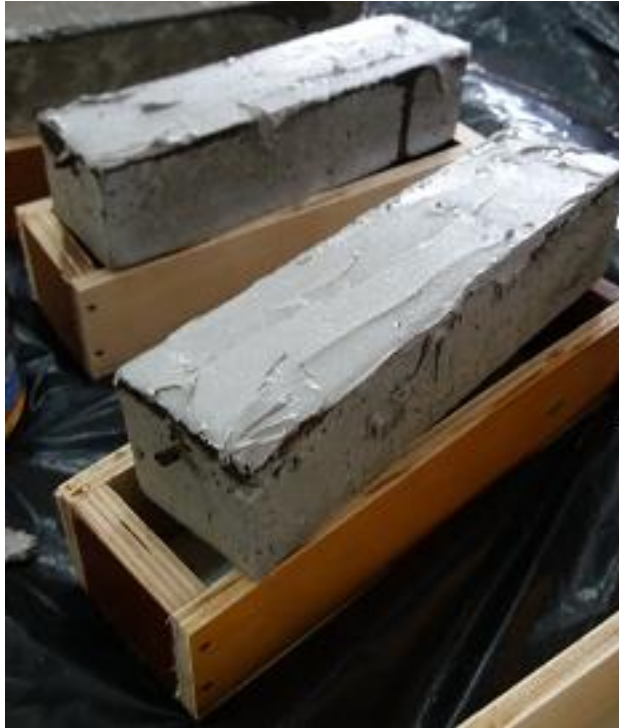
Figura 25 - Vigas com adesivo estrutural Sikadur 31 .
