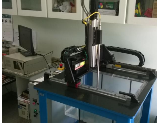
Figura 21 - Equipamento utilizado para inspeção por ultrassom do compósito polimérico.
