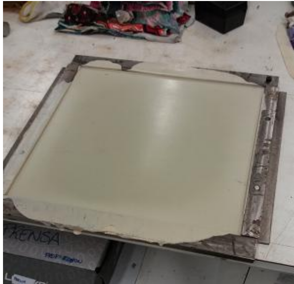
Figura 18 – Compósito de tecido de fibra de vidro e resina epóxi.
