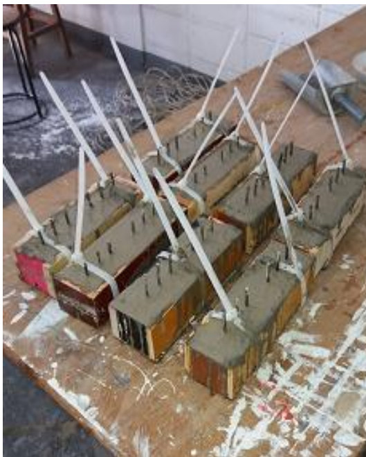
Figura 23 – Formas após concretagem.
