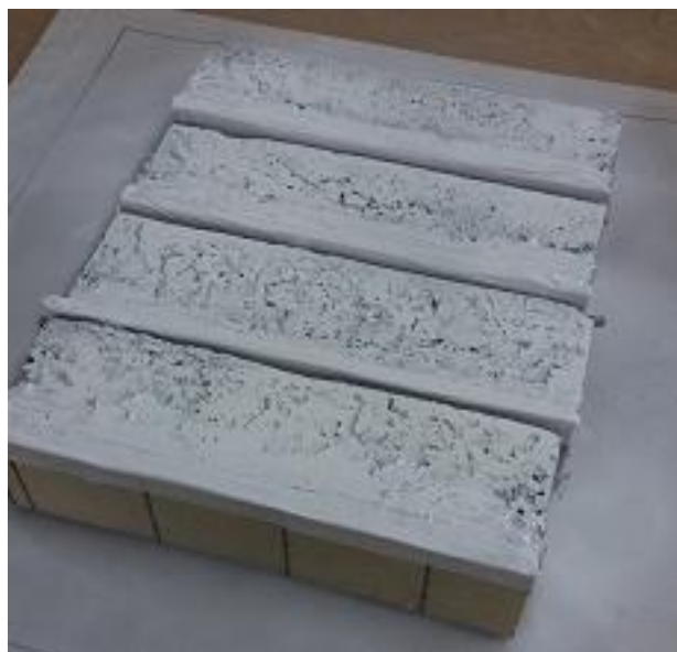
Figura 26 - Vigas com compósito já colado.
