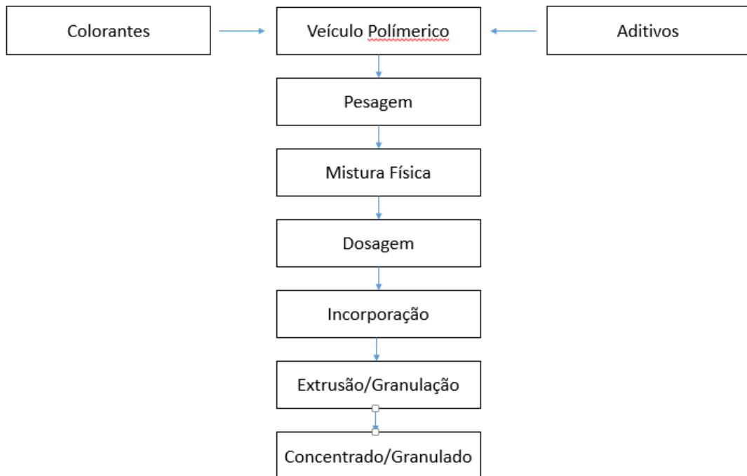
Figura 7 - Processo de produção de Masterbatch
