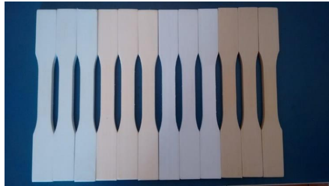
Figura 23 - Corpos-de-prova para ensaio de tração
