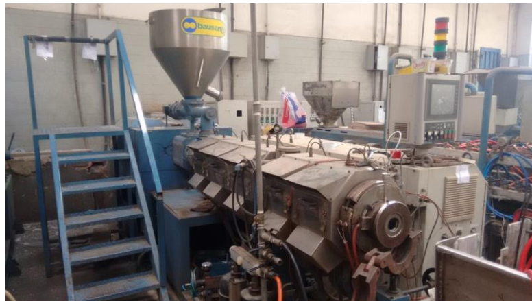
Figura 20 - Extrusora Dupla Rosca usada para a fabricação das amostras
