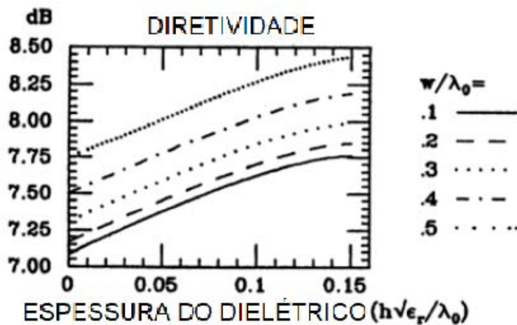
Figura 16 – Diretividade de uma antena patch retangular em função da espessura do substrato
