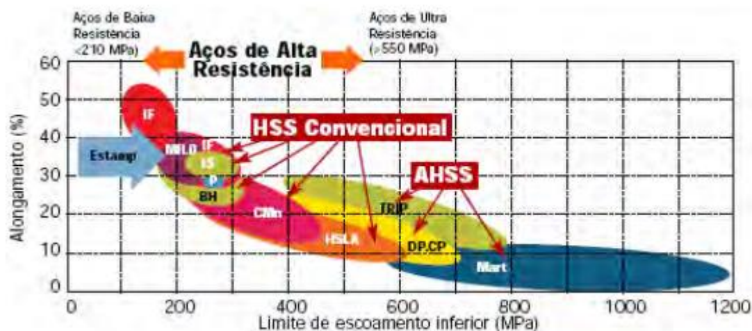
Figura 3 – Aspectos metalúrgicos e mecânicos dos aços indicados pelos projetos ULSAB e ULSAB-AVC.
