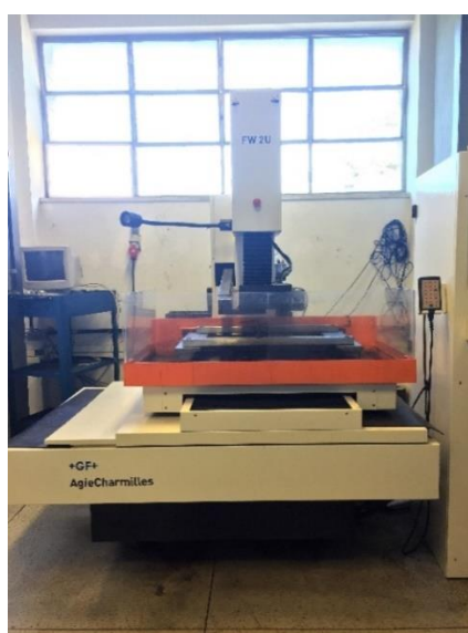
Figura 13 – Máquina CNC AGIE CHARMILLES para seccionamento via eletroerosão à fio.
