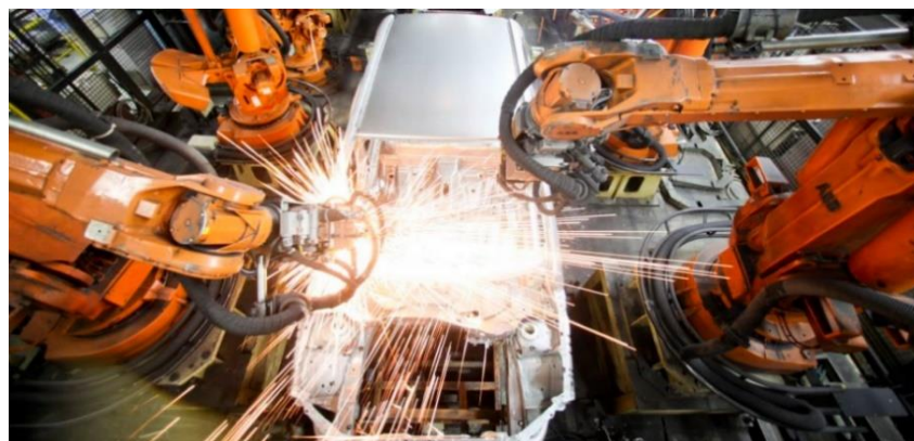
Figura 1.1 – Fagulhamento em robôs de solda automática
