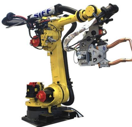
Figura 2.10 – Máquina de solda ponto automática manipulado por robô.
