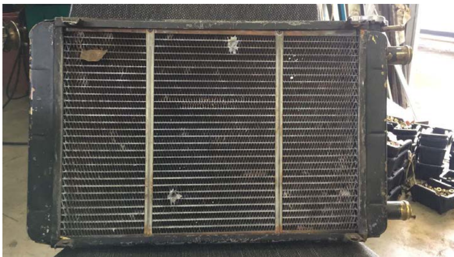
Figura 15 – Radiador de cobre utilizado em 2016
