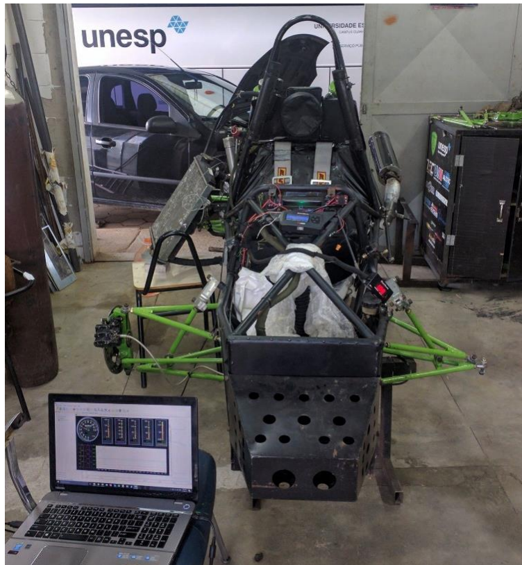
Figura 23 – Testes do radiador 2 no protótipo
