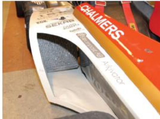
Figura 13 – Duto de resfriamento da equipe Calmers de Formula SAE em 2007
