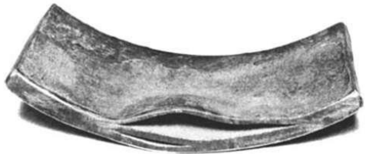
Figura 7 - Falha por empolamento com a) aspecto de bolha e b) desprendimento de camadas.
