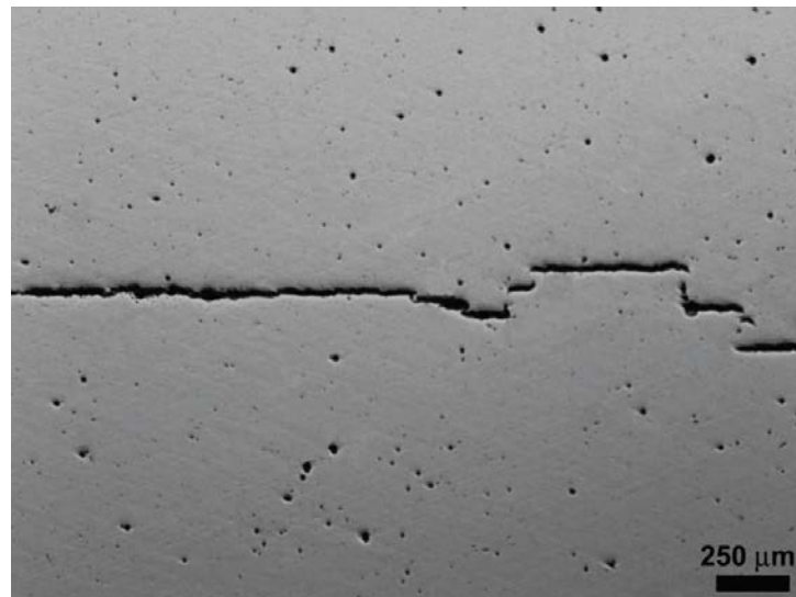
Figura 15 - Fratura induzida por hidrogênio em aço de um tubo API 5L X65 exposto ao meio ácido.
