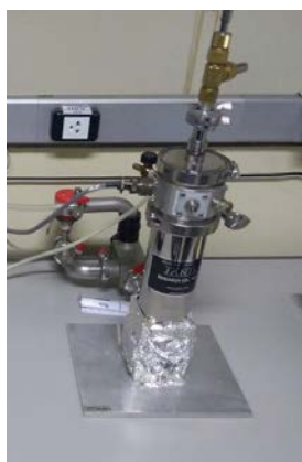
Figura 13- Criostato Janis utilizado para experimentos e caracterizações em função da temperatura
