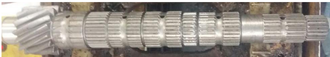
Figura 21 – Corpo de prova do experimento, eixo bruto
