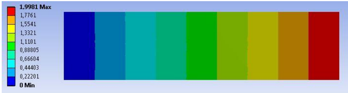
Figura 48 – Deformação do compósito com fibras alinhadas à 90°, em mm
