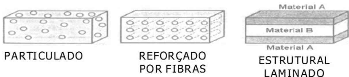
Figura 8 – Ilustração da disposição da fase dispersa nas classes de compósitos
