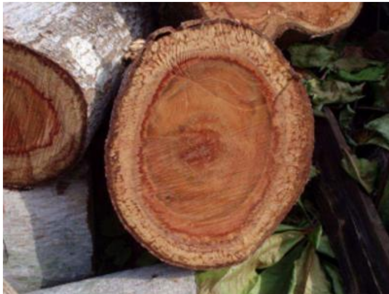
Figura 1 – Ilustração das fases distintas da madeira, um compósito natural
