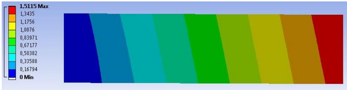
Figura 45 – Deformação do compósito com fibras alinhadas à 30°, em mm
