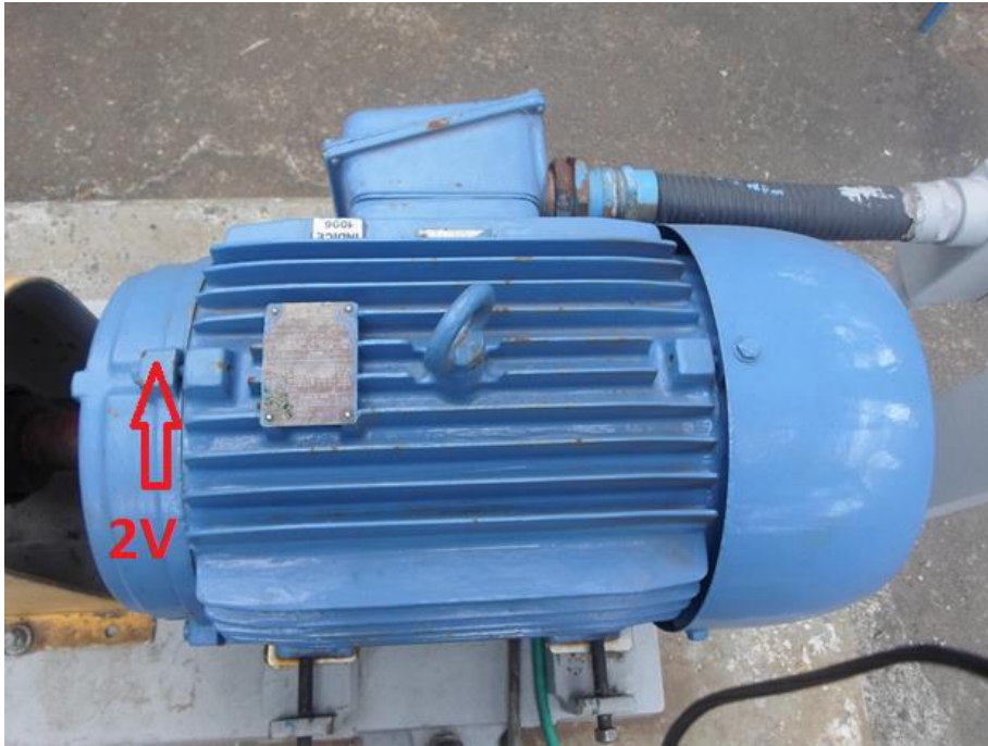
Figura 56 - Pontos de medição do motor, visão de cima
