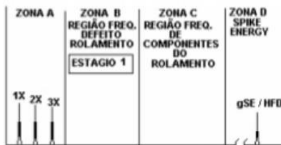
Figura 40 - Gráfico espectral típico de falha de rolamento em 1º estágio
