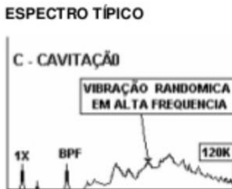
Figura 34 - Gráfico espectral típico de cavitação em bombas centrífugas
