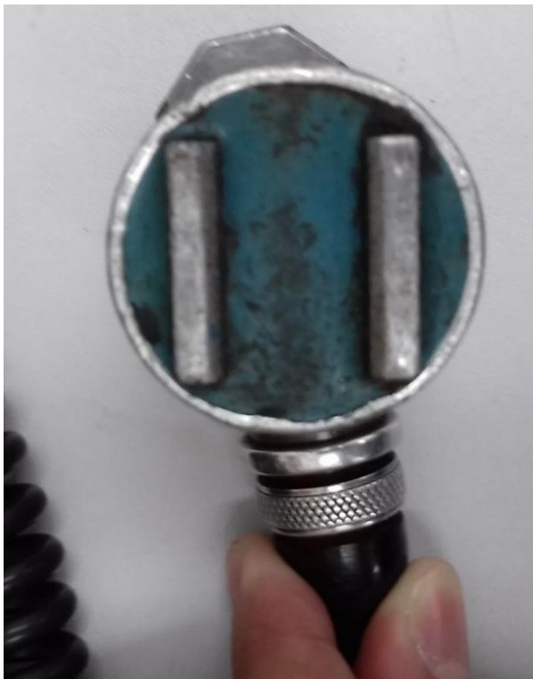
Figura 51 – Fixação de base magnética, visão frontal
