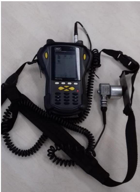
Figura 47 - Microlog GX SKF e acelerômetro piezolétrico dotado de base magnética
