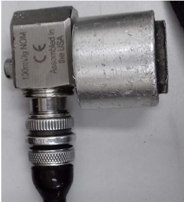
Figura 50 - Acelerômetro dotado de base magnética, visão de perfil
