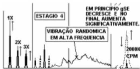
Figura 43 - Gráfico espectral típico de falha de rolamento em 4º estágio
