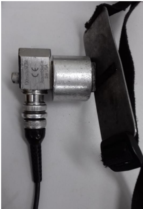
Figura 49 - Acelerômetro com base magnética
