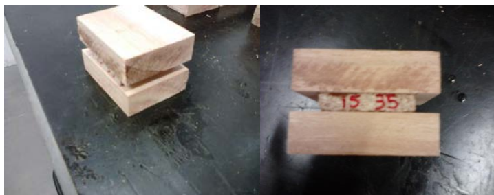
Figura 25- Corpo de prova colado nas sapatas
