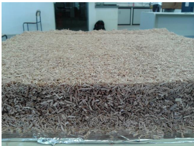
Figura 16- Colchão de partículas destacando as camadas externas e internas
