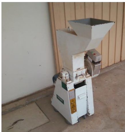
Figura 9: Modelo de picador
