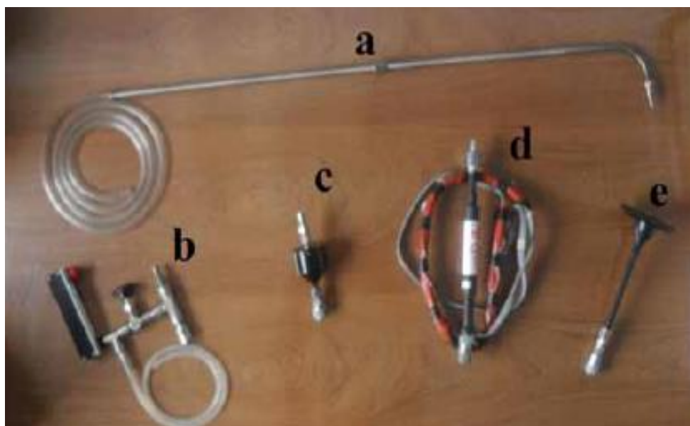
Figura 4 - Acessórios DataRAM 4. (a) Sonda isocinética; (b) Diluidor de partículas; (c) Seletor de partículas; (d) Aquecedor; (e) Entrada omnidirecional.
