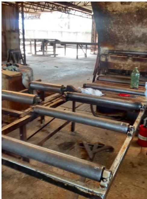
Figura 17 - transportador de rolo livre
