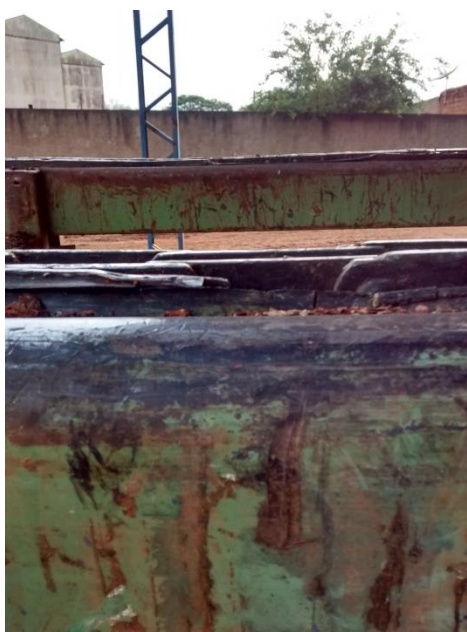
Figura 12 - Detalhe do desgaste do transportador.
