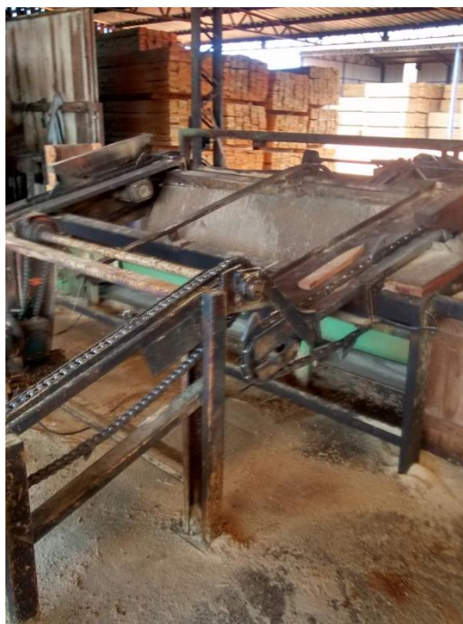
Figura 18 - transportador tipo corrente (entrada do tanque)
