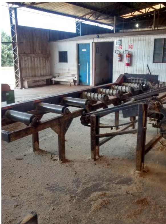
Figura 16 - Transportador tipo rolo
