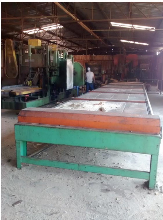
Figura 20 - Transportador de Refilo e aparas
