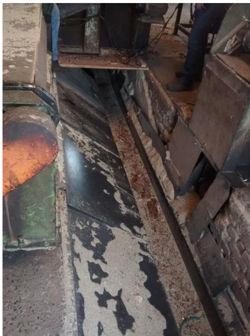
Figura 21 - Esteira transportadora de resíduos
