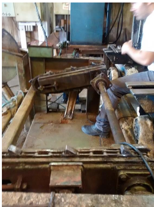
Figura 13 - Rotacionador de toras
