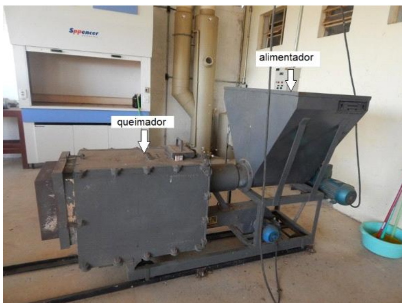
Figura 6 – Sistema de queima de biomassa – queimador ligado a um alimentador
