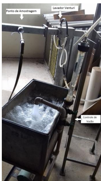
Figura 8 – Módulo experimental de controle de gases: Lavador Venturi (a) e Ciclone (b)
