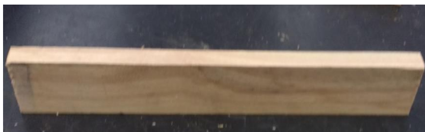
Figura 32 - Corpo de prova adaptado para o ensaio de flexão segundo a norma ABNT NBR 7190:1997.
