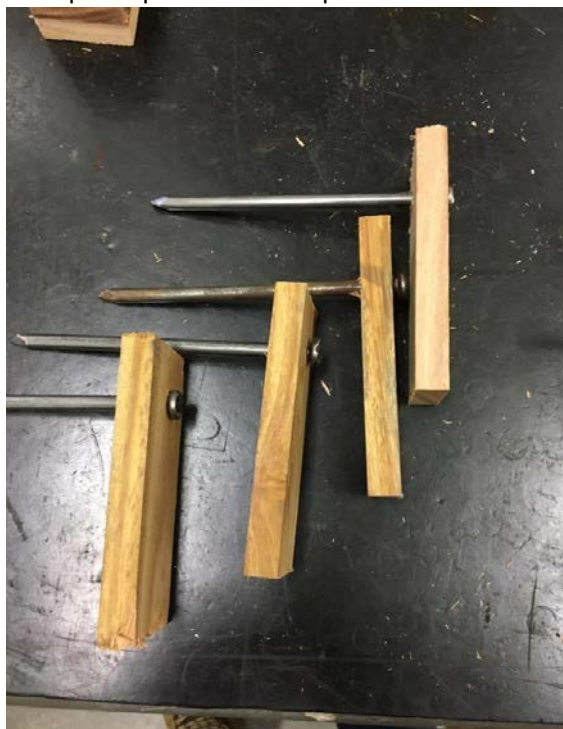
Figura 38 - Corpo de prova utilizado para o ensaio de embutimento.
