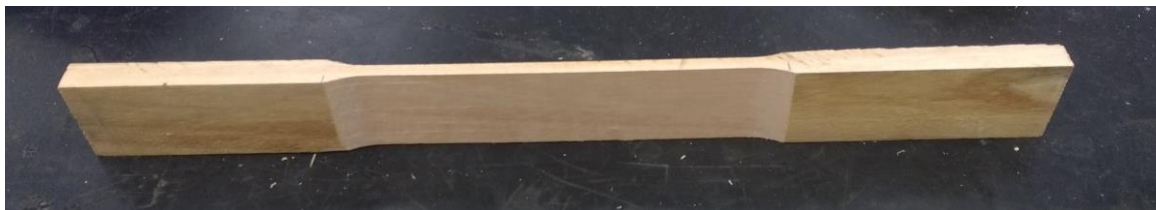
Figura 27 - Corpo de prova adaptado para tração paralela às fibras de acordo com a norma ABNT NBR 7190:1997.
