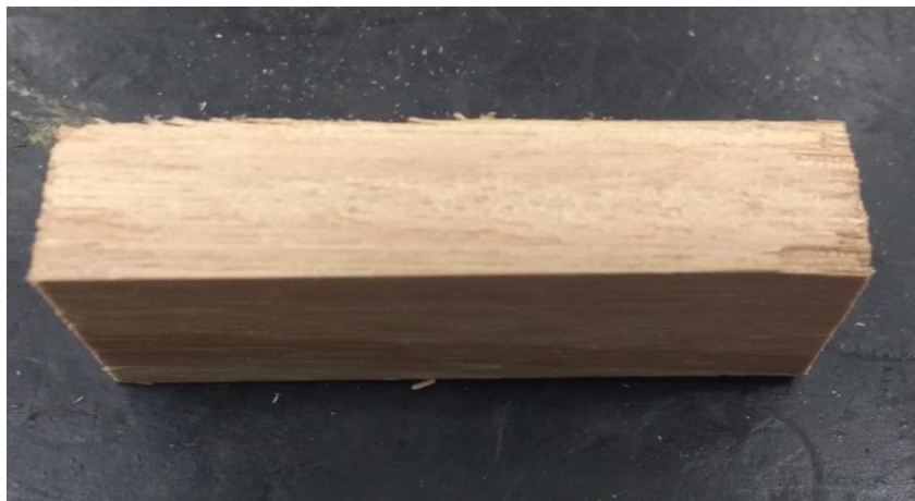
Figura 29 - Corpo de prova para o ensaio de compressão paralela as fibras segundo a norma ABNT NBR 7190:1997.
