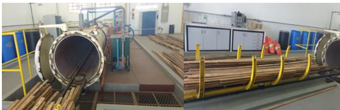
Figura 44 - Tratamento preservativo das peças de madeira.
