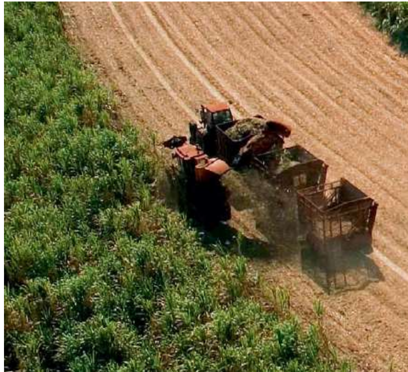
Figura 9 - Colheita da cana de açúcar sendo realizada por colhedora CASE A8800, Trator CASE Magnum 240 em conjunto com 02 transbordos.
