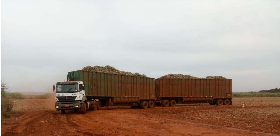
Figura 12 – Exemplo de Rodotrem utilizado no transporte de cana de açúcar picada.
