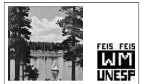
(h) Atacada (.JPG 70%) e Marca Extraída - DWT-DCT.
