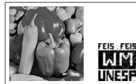
(k) Atacada (.JPG 50%) e Marca Extraída - DWT-DCT.
