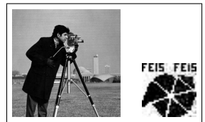
(h) Atacada (.JPG 70%) e Marca Extraída - DWT-DCT.
