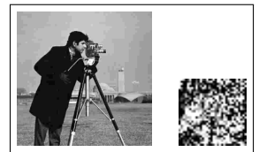
(p) Atacada (.JPG 10%) e Marca Extraída - DWT-DCT.
