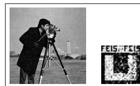
(w) Atacada Ruído Sal e Pimenta e Marca Extraída - DWT-DWT-DCT.
