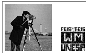
(m) Atacada (.JPG 20%) e Marca Extraída - MARDI-DWT-DCT.
