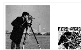
(w) Atacada Ruído Sal e Pimenta e Marca Extraída - DWT-DCT.
