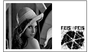
(l) Atacada (.JPEG 30%) e Marca Extraída - DWT-DCT.
