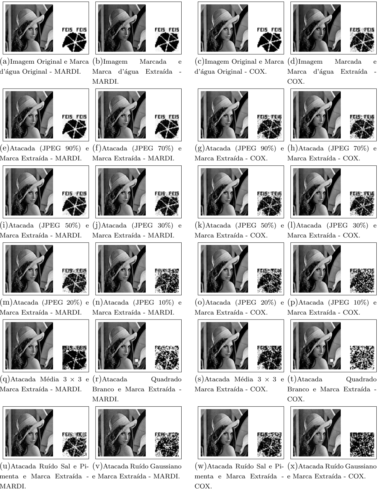
Figura 26 – Resultados obtidos com a implementação do método MARDI e técnica de Cox et al.
