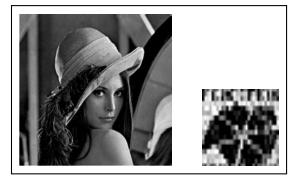
(d) Imagem Marcada e Marca d'água Extraída - COX(DFT).
