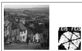
(i) Atacada (.JPG 50%) e Marca Extraída - MARDI-DWT-DCT.
