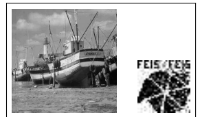
(l) Atacada (.JPG 30%) e Marca Extraída - DWT-DCT.
