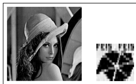
(e) Atacada (JPEG 90%) e Marca Extraída - MARDI.
