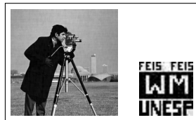
(i) Atacada (.JPG 50%) e Marca Extraída - MARDI-DWT-DCT.
