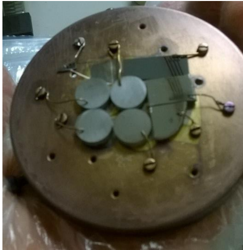
Figura 5: Substratos de titânio, sílica, silício e titânio nióbio presos no porta-substratos, prontos para deposição.
