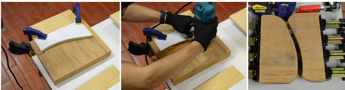
Figura 41 - Produção dos moldes Macho e Fêmea com fixação dos gabaritos e corte com tupa. Fonte: do autor.
