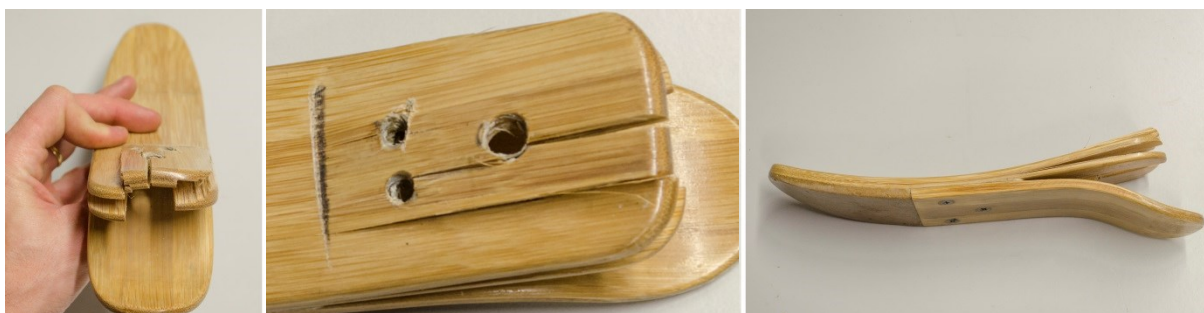
Figura 62 - Detalhes do corpo de prova após ruptura do ensaio cíclico. Fonte: do autor.
