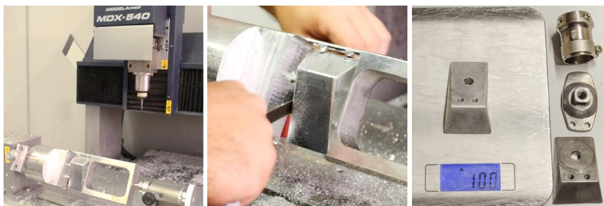
Figura 51 - Usinagem do Adaptador Angular em Alumínio e pesagem do componente. Fonte: do autor.
