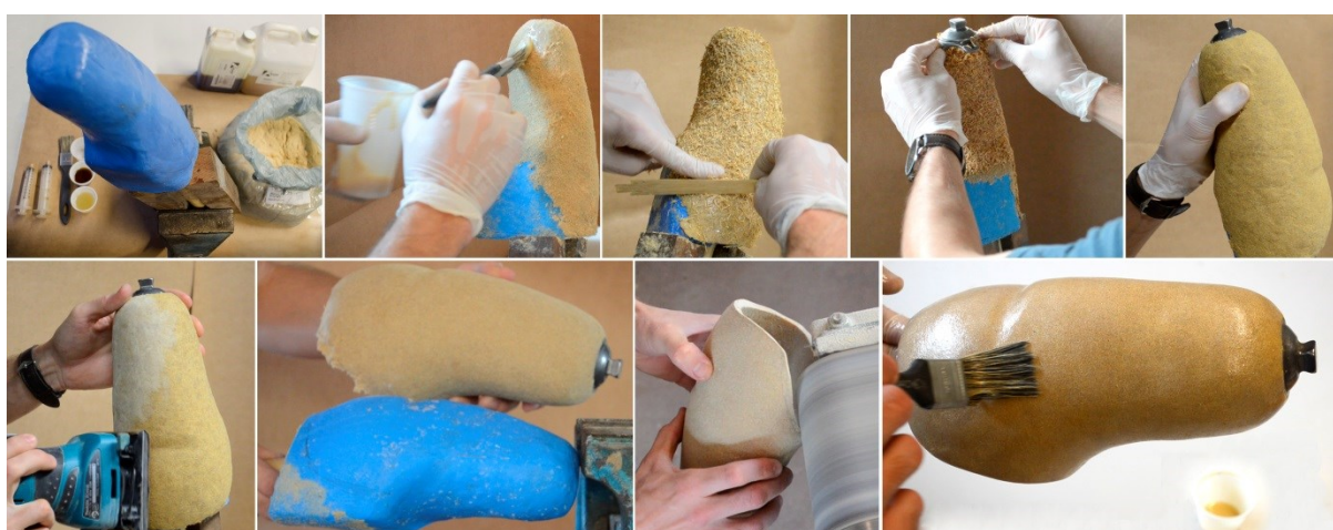
Figura 50 - Preparação do molde positivo e laminação das camadas de acabamento interno, estrutura e acabamento externo. Fonte: do autor.
