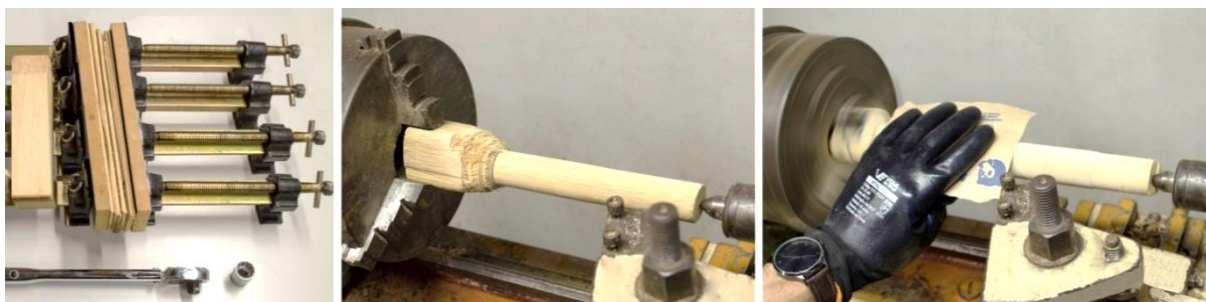
Figura 49 - Procedimento de prensagem, torneamento e acabamento do cilindro de BLaC da prótese. Fonte: do autor.
