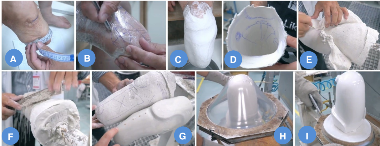
Figura 10 – Etapas de confecção de um soquete. A - Dimensionamento do Coto; B - Destaque das Áreas de Carga e Descarga; C - Confeção do Molde Negativo; D - Confeção do Molde Positivo; E - Determinação das áreas de pressão; F - Acabamento do Molde Positivo; G - Moldagem da Estrutura do Soquete; H - Estrutura Finalizada. Fonte: Manual do Mundo: Como é feita uma prótese, 2017.
