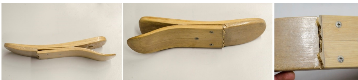
Figura 68 - Detalhes da ruptura do corpo de prova do ensaio estático - Proof Test Force : Condição II. Fonte: do autor.
