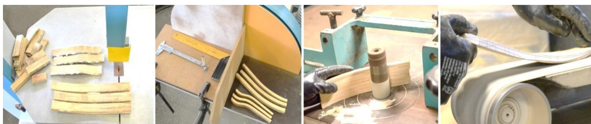
Figura 47 – Corte e lixamento lateral, superior e inferior das peças de BLaC produzidas para confecção do pé protético. Fonte: do autor.
