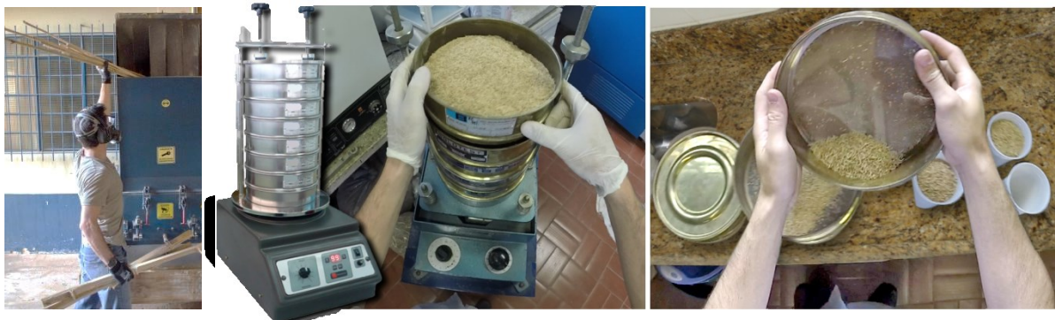
Figura 37 - Processo de obtenção das fibras do bambu com Trituração dos resíduos no moinho de martelos e granulometria das fibras com destaque para a peneira vibratória utilizada. Fonte: do autor.
