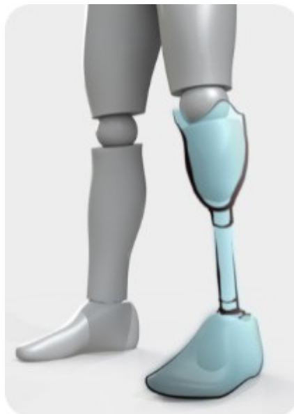
Figura 2 - Representação de uma prótese transtibial endoesquelética. Fonte: Santos et al. (2018).
