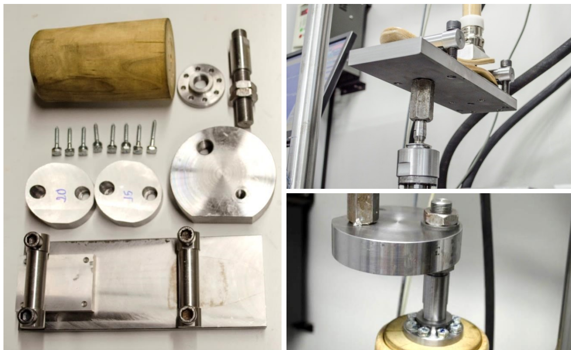
Figura 52 - Dispositivos fabricados conforme norma 10328:2016 para instalação da prótese nas máquinas. Fonte: do autor.
